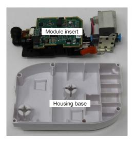
Fig. 89: Dismantling the drain module
