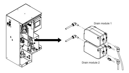
Fig. 88: Replacing the drain module
