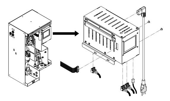
Fig. 95: Replacing the ConBox
